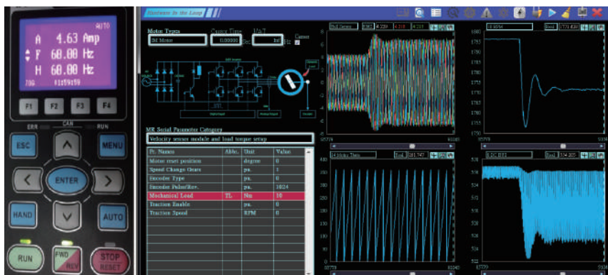
◆ 即時監控電機與變頻器狀態
